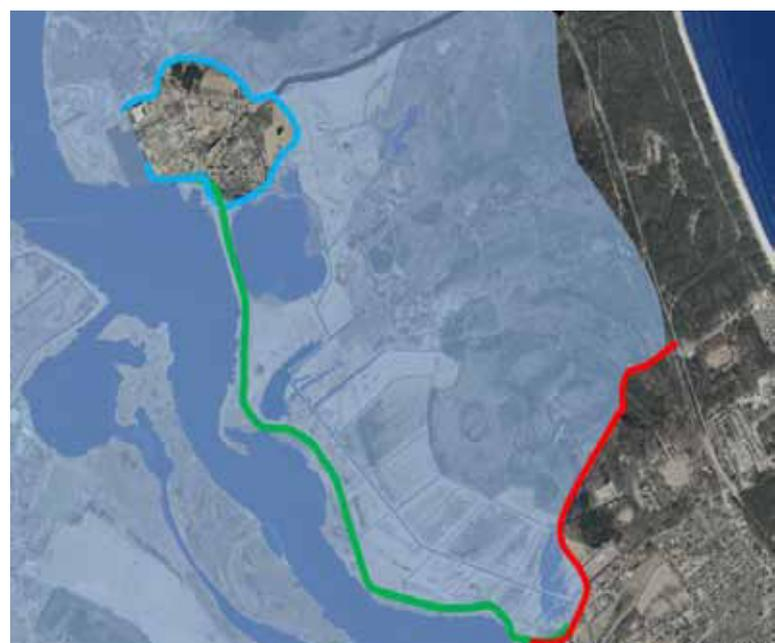
Küstenschutztechnische Situation bei Extremereignissen mit Überströmung der Landesstraße (blau = Neubau Ringdeich Peenemünde, rot = Neubau Riegeldeich Karlshagen, grün = bestehender Peenestromdeich)
