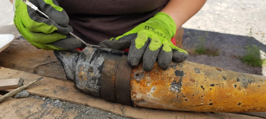
Eine Praktikantin bei der Reinigung eines Trimmgewichtes einer Henschel Hs 293
