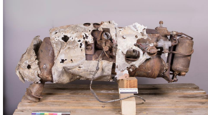
Triebwerk einer Henschel 293 mit Resten der Verkleidung nach der Reinigung
